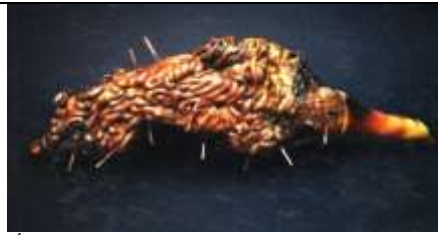
شكل ( ٤٢ ) ترسيب طبقة من النحاس الأحمر على قطعة مشكلة من البلاستيك
